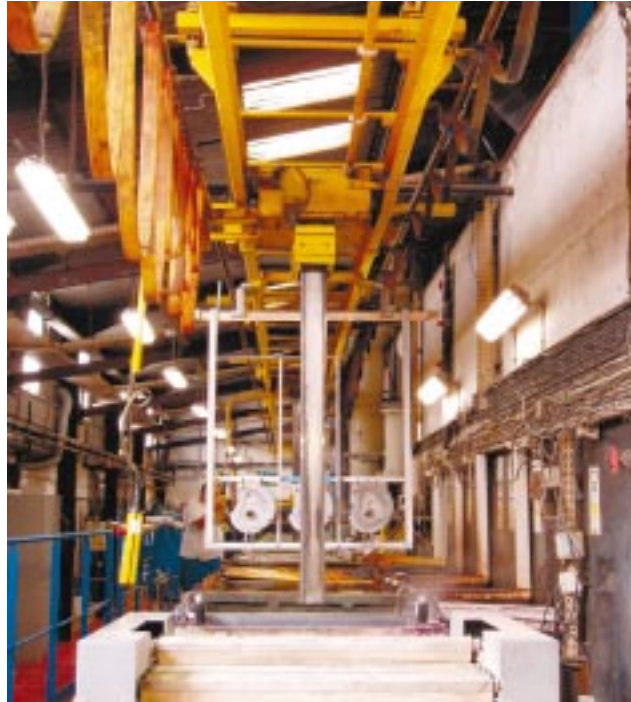
Mecaprotec utilisera le revêtement zinc-nickel pour des pièces en acier destinées à l'aéronautique.
